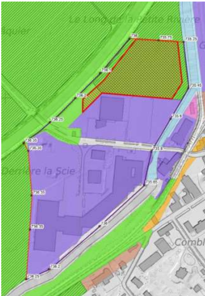
Figure 11 : lignes d'étanchéité avec les cotes à respecter autour de la zone industrielle (Cf. annexe 4)
