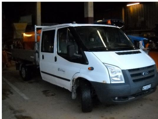
Ces deux véhicules utilitaires servent à transporter les collaborateurs des équipes sur les chantiers ; de plus, pour les missions hivernales, ceux-ci sont équipées de saeuses portées, d'où le besoin qu'ils soient équipés d'une transmission intégrale 4x4 et d'un pont basculant.
