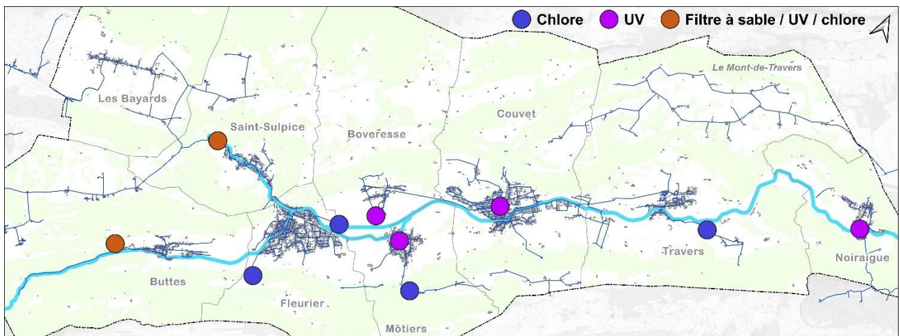
Figure 13 : situation des installations de traitement
